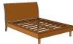
Cadre avec barres 2 po (l'espace entre les barres ne doit pas dépasser 2 po de largeur (5,08 cm))
